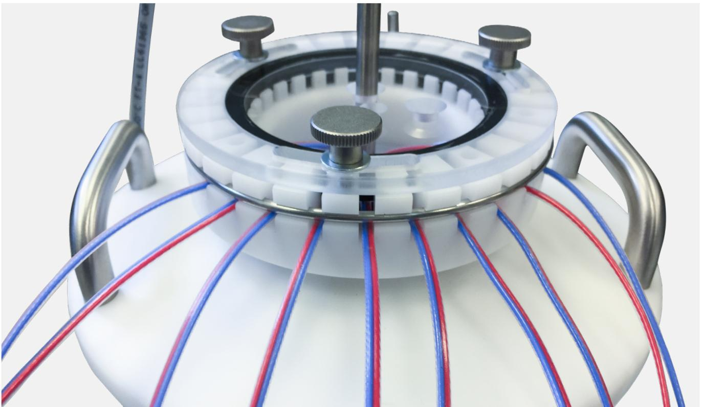
O Comparador Kaye de Nitrogênio Líquido (LN2) é um dispositivo projetado especificamente para atender às necessidades de calibração para temperaturas extremamente frias. Com a capacidade de calibrar até 48 Sensores de cada vez, atende às necessidades de capacidade e flexibilidade para calibração térmica a temperaturas criogênicas.
