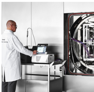
Bild 21: Kaye Validator AVS im Einsatz Dampfsterilisator
